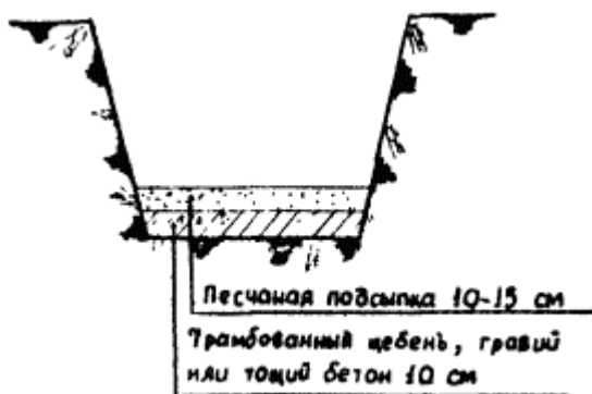
Рис. 6. Подготовка дна траншеи к укладке труб
