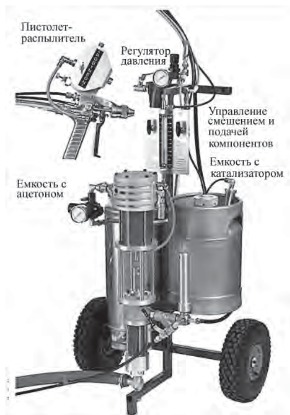
Рис. 2. Устройство для распыления смолы и стекловолокна при ручном формовании
