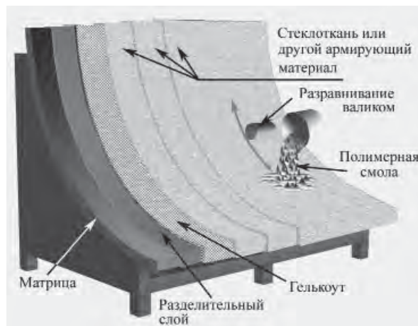
Рис. 1. Ручное формование ламината
