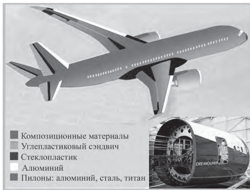
Рис. 6. использование композитных материалов в авиалайнере «Боинг 787»
